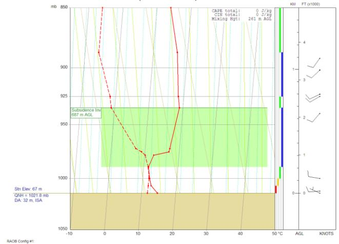
**Figura 6. Perfiles de temperatura en la atmósfera obtenidos a partir de los radiosondeos decodificados con el programa RAOB.**
