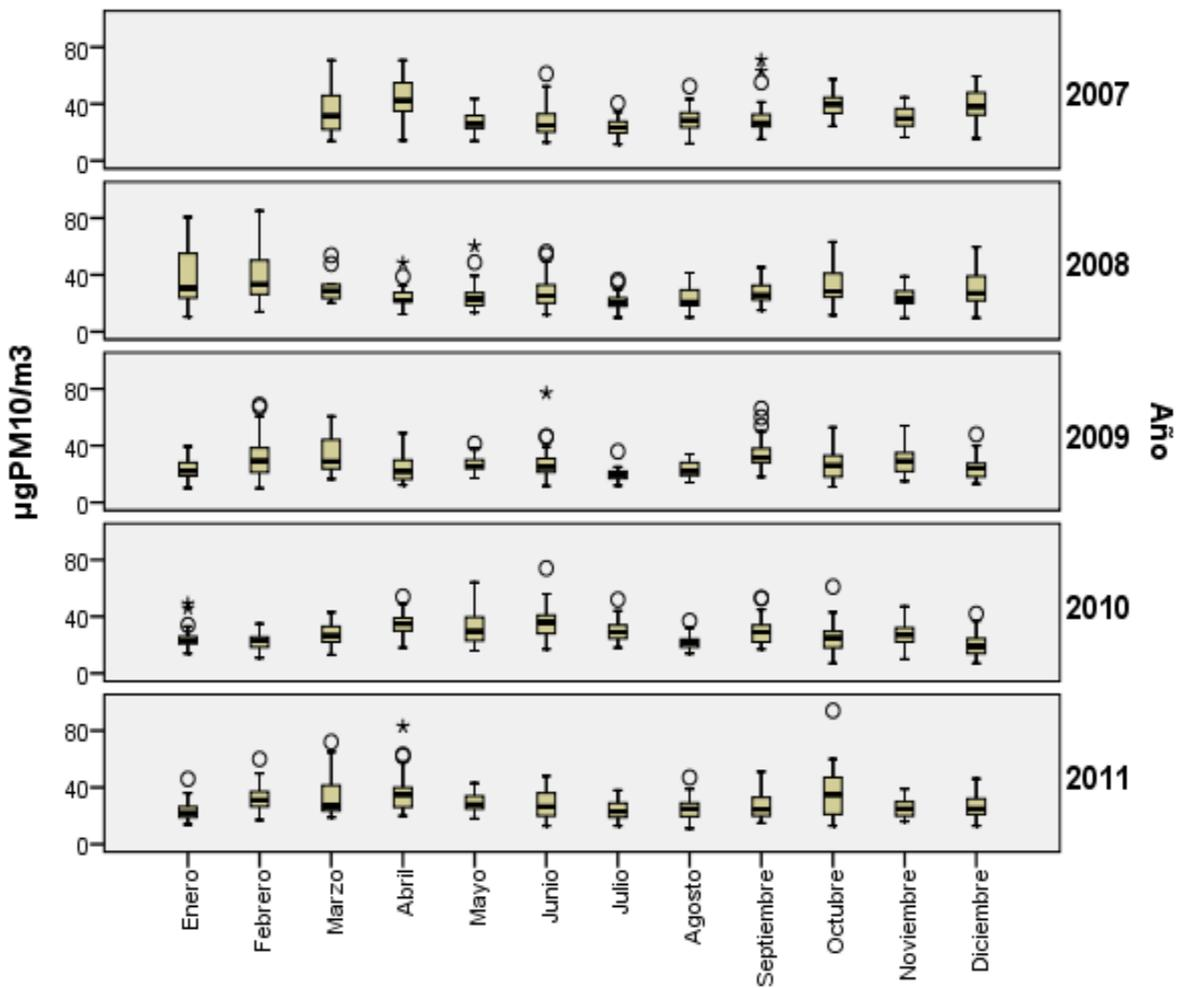
Figura 27. Diagramas de Box-Whisker del valor promedio 24 h (método gravimétrico) para los diferentes meses de muestreo desde el año 2007 a 2011.
