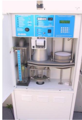
Figura 2. Fotografías (exterior e interior) del equipo de muestreo DIGITEL DHA-80.
